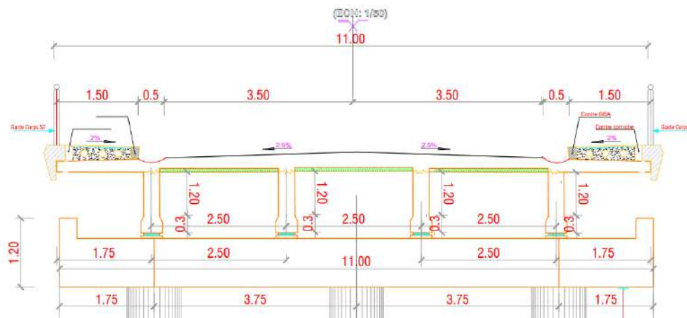
Figure 5 : Coupe transversale type du tablier sur culée
